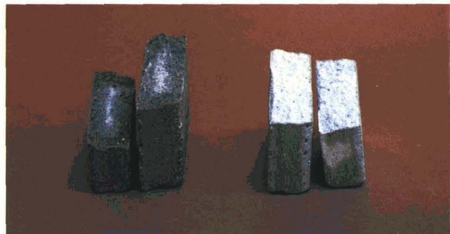
マノール防水剤の混入効果(右) 水中浸漬した後破断
