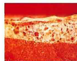
▲バンデックスを表面に塗布したコンクリート切断面、白い部分がコンクリート躯体に浸透して形成されたバンデックス結晶体です。
