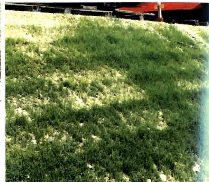
▲ オーダス施行部分の植生状況。 ▶ オーダスにより種子の落下を抑え、水平ドレン効果と合わせ、良好な植生を促す。
