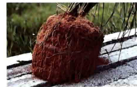
●植生実験：根はオーダス（ソフトタイプ）を貫通
