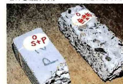
▲屋外暴露10年後の水中凍結融解による劣化状況。(S+P塗布の劣化が少ない)
