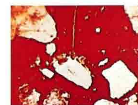
▲中央のタテ線は毛細管に浸透したバンデックス結晶体です。
