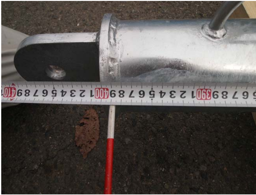
【写真タイトル】社内検査 【写真 - 大分類】工事 【写真区分】品質管理写真 【工種】製作工 【細別】係留ビーム（下流側） 【工種区分予備】全長 設計値3991 実測値3992
