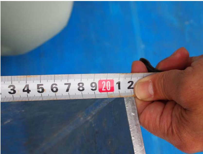
【写真タイトル】社内検査 【写真 - 大分類】工事 【写真区分】品質管理写真 【工種】製作工 【細別】護岸側ビームヒンジ受け金具 【工種区分予備】ヒンジ 高さ 設計値212 実測値212
