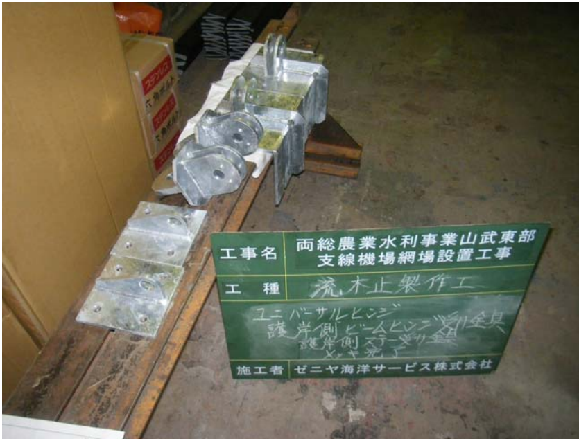
【写真タイトル】メッキ完了 【写真 - 大分類】工事 【写真区分】施工状況写真 【工種】製作工 【種別】ビーム 【細別】ユニバーサルヒンジ、護岸側ビームヒンジ受け金具、護岸側ステー受け金具
