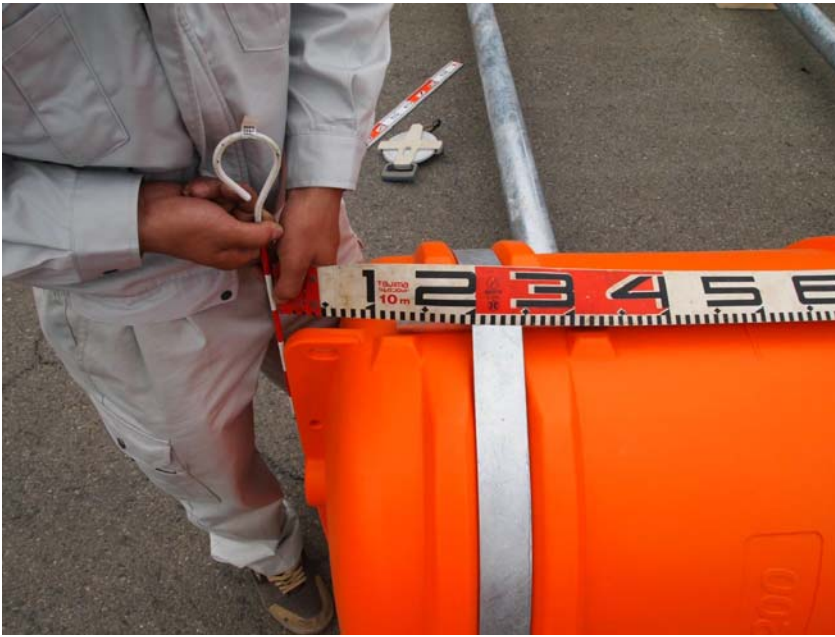
【写真タイトル】社内検査 【写真 - 大分類】工事 【写真区分】品質管理写真 【工種】製作工 【細別】フロート 【工種区分予備】全長 設計値1000 実測値1000
