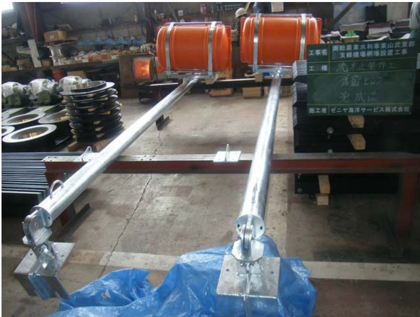
【写真タイトル】完成品 【写真 - 大分類】工事 【写真区分】施工状況写真 【工種】製作工 【種別】ビーム 【細別】係留ヒンジ
