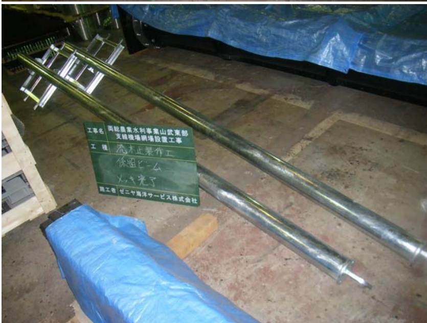
【写真タイトル】メッキ完了 【写真 - 大分類】工事 【写真区分】施工状況写真 【工種】製作工 【種別】ビーム 【細別】係留ビーム
