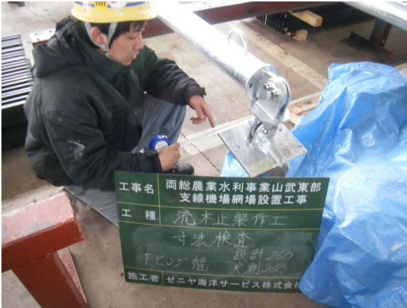
【写真タイトル】寸法検査（自主検査） 【写真 - 大分類】工事 【写真区分】施工状況写真 【工種】製作工 【種別】ビーム 【細別】護岸側ビームヒンジ受け金具 【工種区分予備】ヒンジ幅 設計値260 実測値260
