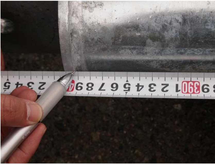
【写真タイトル】社内検査 【写真 - 大分類】工事 【写真区分】品質管理写真 【工種】製作工 【細別】係留ビーム（上流側） 【工種区分予備】全長 設計値3991 実測値3992
