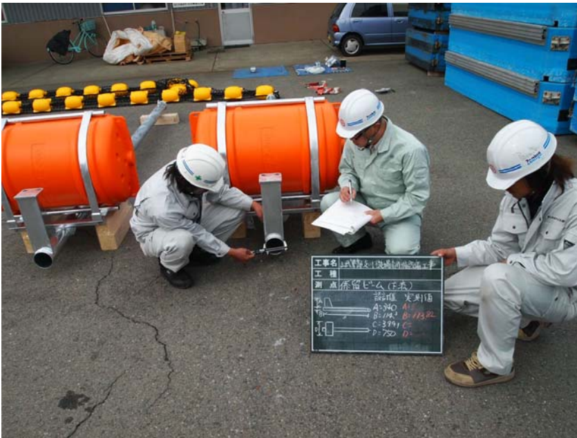
【写真タイトル】社内検査 【写真 - 大分類】工事 【写真区分】品質管理写真 【工種】製作工 【細別】係留ビーム（下流側） 【工種区分予備】パイプ径 設計値114.3 実測値113.82
