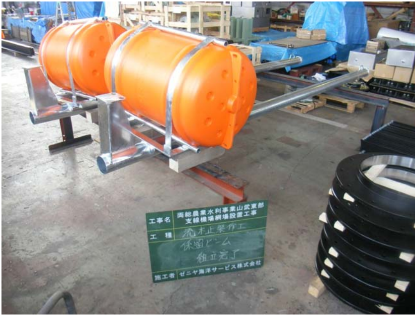
【写真タイトル】組立完了 【写真 - 大分類】工事 【写真区分】施工状況写真 【工種】製作工 【種別】ビーム 【細別】係留ビーム
