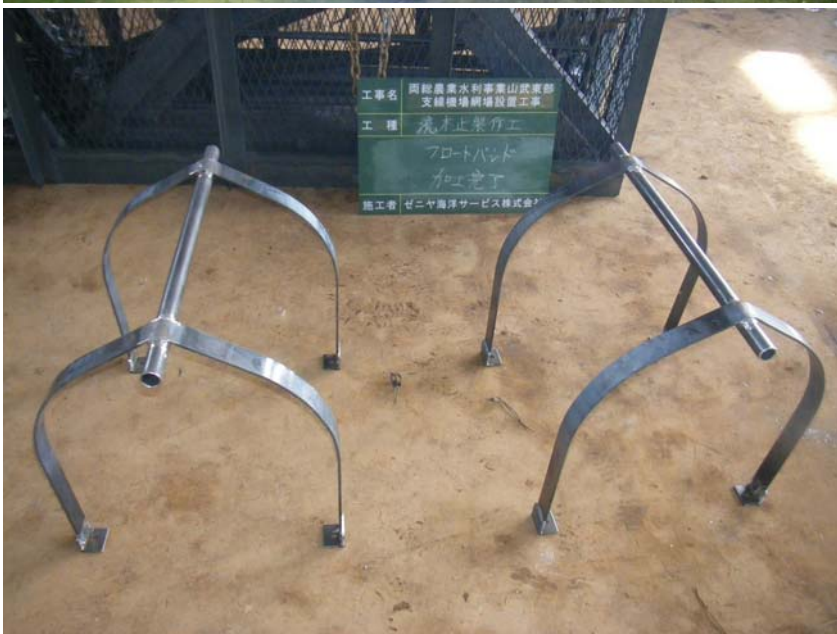
【写真タイトル】加工完了 【写真 - 大分類】工事 【写真区分】施工状況写真 【工種】製作工 【種別】ビーム 【細別】フロートバンド
