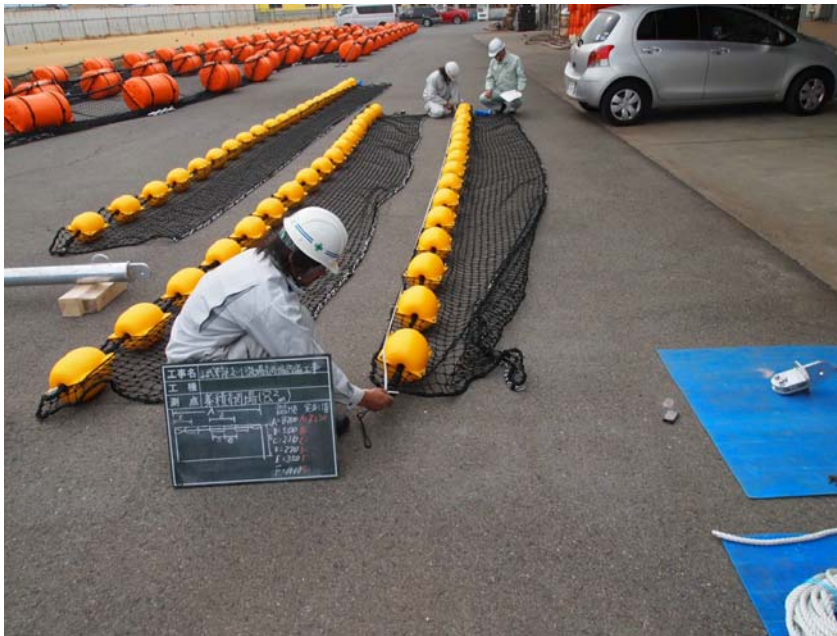
【写真タイトル】社内検査 【写真 - 大分類】工事 【写真区分】品質管理写真 【工種】製作工 【細別】集積網場（8.2m） 【工種区分予備】全長 設計値8200 実測値8230
